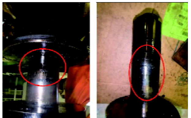
图5 积炭严重的喷油柱塞下部
